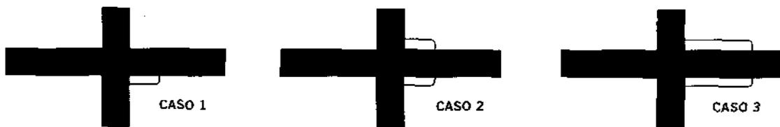
↑ Figura 16.18 Esquemas de los tres casos de aislamiento considerados para el puente P04. La banda amarilla corresponde a una capa de aislante. En todos los casos se supone que el aislante está por el lado externo, es decir en la proyección hacia el exterior.
