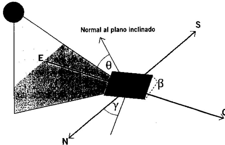
↑ Figura 16.6 Ángulos definidos para la definición de un plano inclinado con respecto a un plano horizontal.
