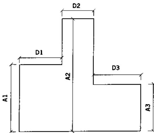
↑ Figura 7.13 Elevación de obstáculo con altura variable
