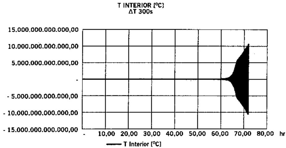
↑ Figura 16.1 Respuesta de temperatura interior resuelta en intervalos de 300
