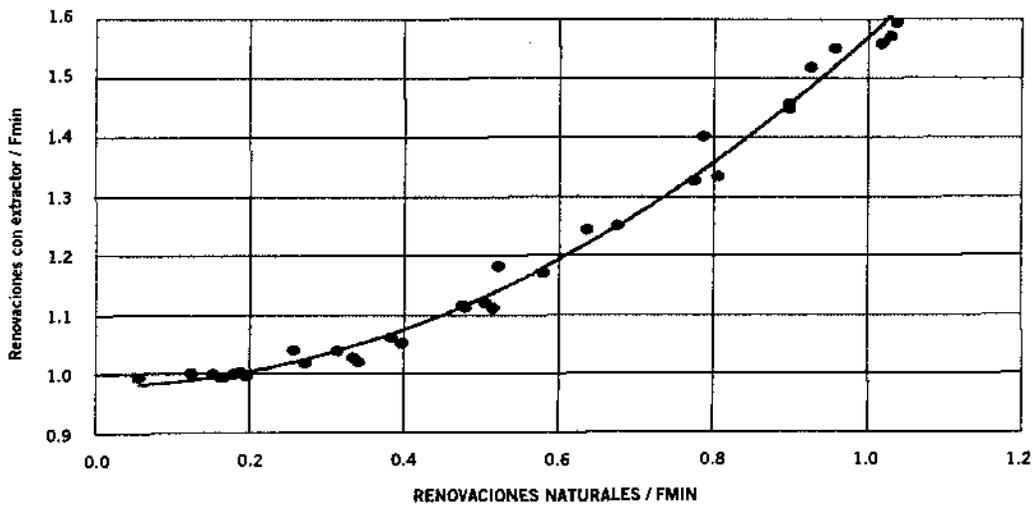
↑ Figura 16.15 Relación entre las renovaciones de aire naturales de una vivienda y las renovaciones de aire que tendría esta misma vivienda después de instalar un extractor de aire de  $F_{min}$  [ren/h]
