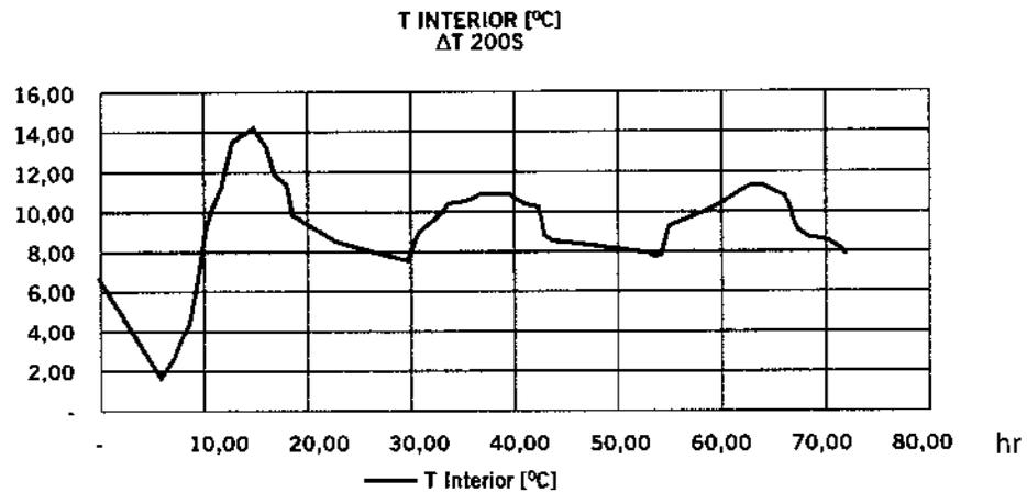
↑ Figura 16.3 Respuesta de temperatura interior resuelta en intervalos de 200s
