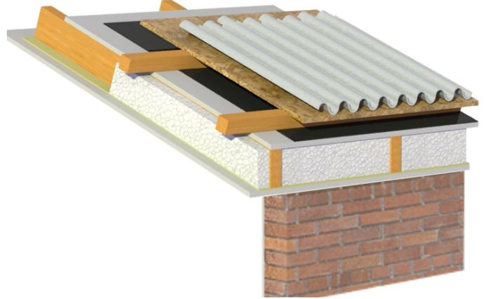
NOTA : El material aislante térmico deberá cubrir el área del alero para que no se produzca "Puente Térmico", dejando libre de aislación térmica solo el área de la ventilación del alero en el caso que exista.
