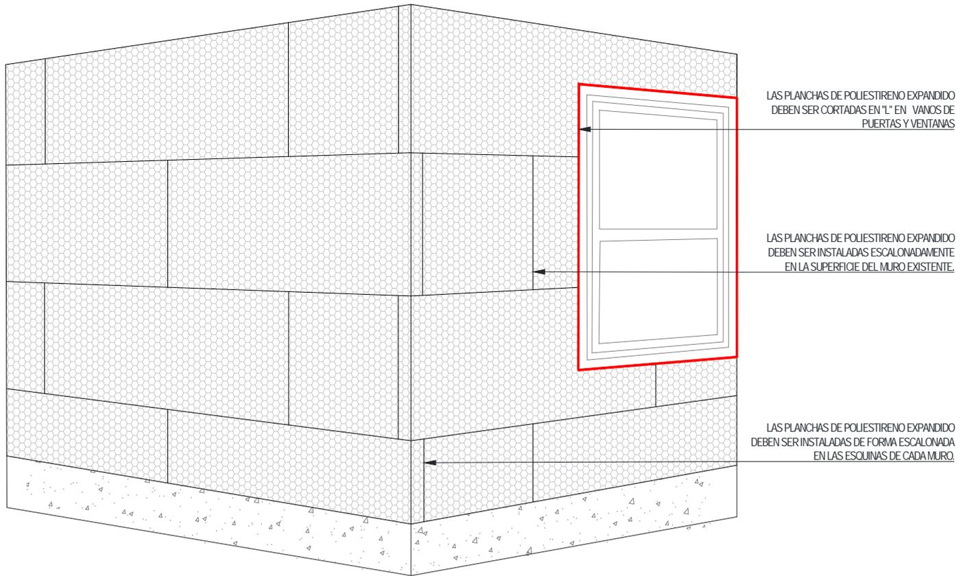
FIGURA N°2: DETALLE INSTALACIÓN MALLAS DE REFUERZO EN VANOS DE VENTANAS Y PUERTAS.
